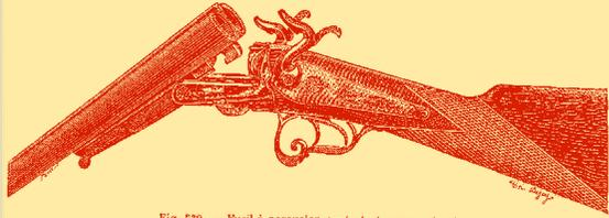
Fig. 239. — Fusil à percussion centrale à verrou simple.
