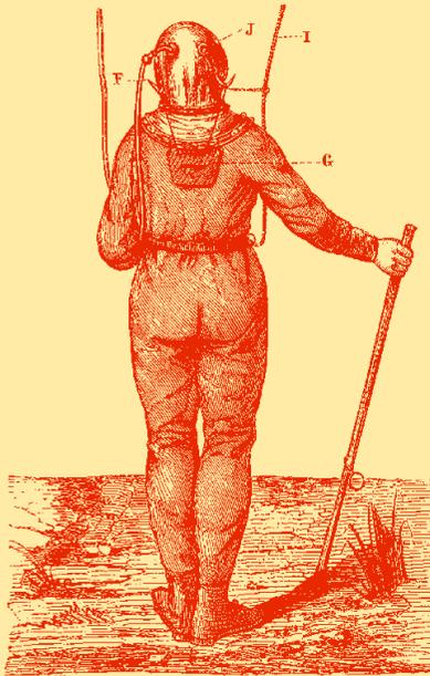
Fig. 402. — Plongeur revêtu de l'appareil Cabriol, vu de dos.
